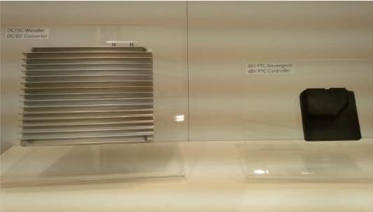
左：48V DC-DCコンバーター，右：PTCヒーター
