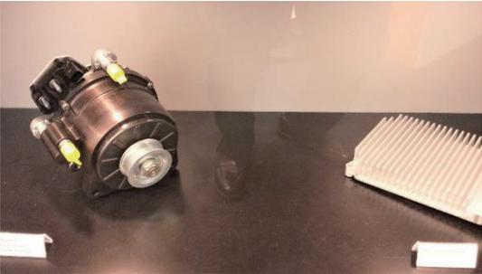
左：48V ISG，右：48V DC-DC Converter
