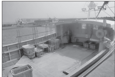
図3-1c コンテナで整理された漁獲物置場
